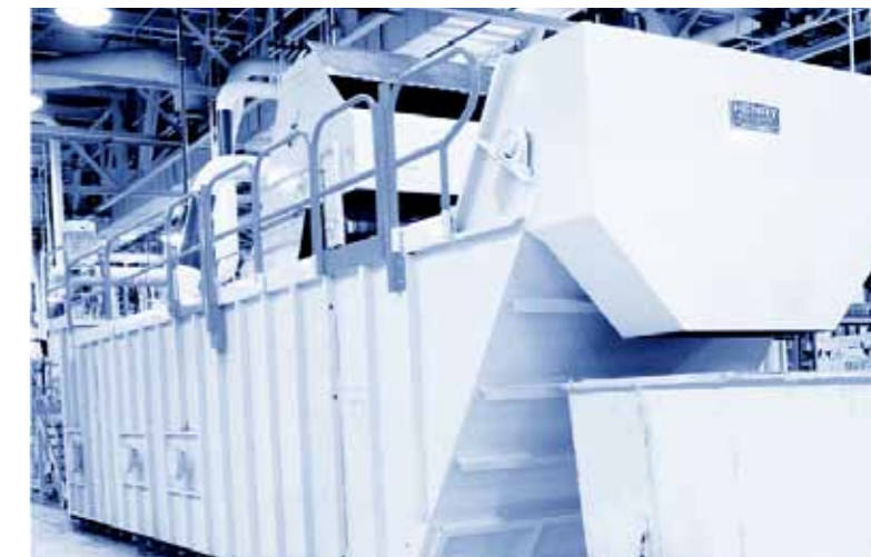
Der wartungsfreundliche STEB-Filter erfordert keine Spezialwerkzeuge zur Installation von Endlosband und Auflagegitter.
