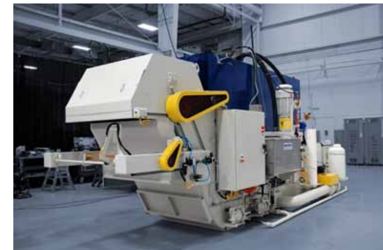
Das TRVD ist wartungsarm und es werden keine Spezialwerkzeuge zur Installation von Endlosband und Auflagegitter benötigt.
